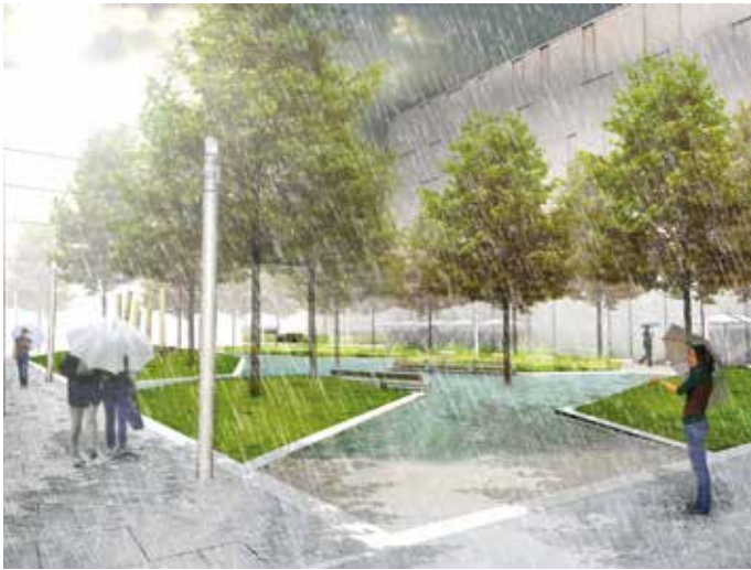
Pocketpark im Löwitz Quartier Leipzig: bei Starkregeneignis mit Anstau des Regenwassers auf der Überflutungsfläche (Quelle: bgmr Landschaftsarchitekten GmbH)
