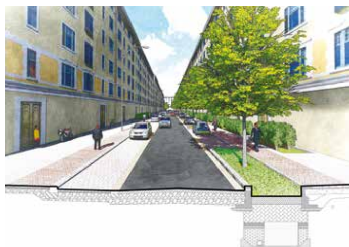
links: Ansicht einer Baumrigole mit unterirdischem Speicherraum am Pilotstandort Kasseler Straße in Leipzig / rechts: Prinzipskizze eines Mulden-Rigolen-Systems (Quelle: © Ingenieurgesellschaft Prof. Dr. Sieker mbH)
