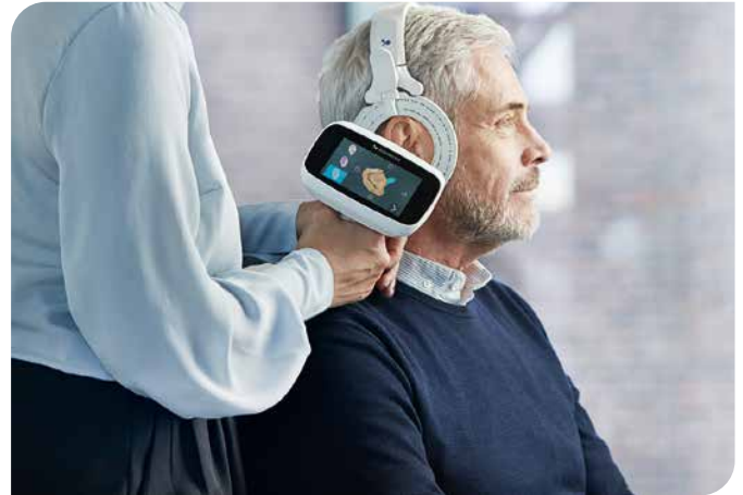
Das Handwerk nutzt modernste Technologien – hier erfolgt die Ohrabformung mit 3-D-Scanner, statt das äußere Ohr mit Silikon abzuformen. (Foto: Otoscan)
