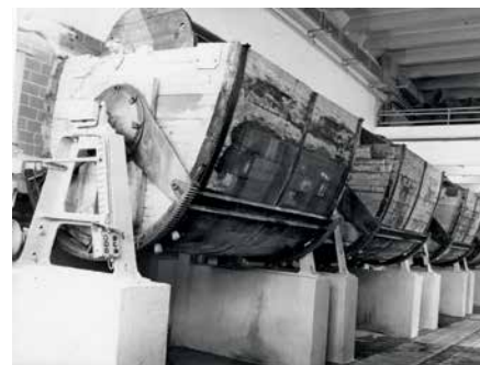
Gerberei = Prozess, in welchem das Haar dauerhaft im Leder fixiert wird und das Leder selbst geschmeidig gemacht wird.
