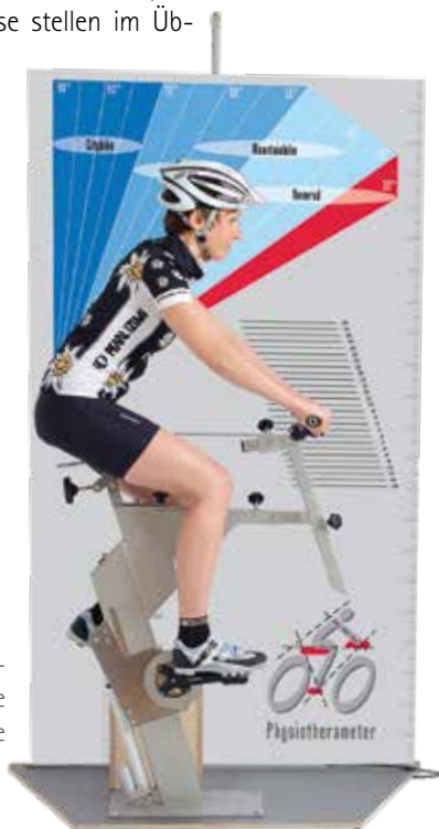
Mithilfe des sogenannten Physiotherameters wird die richtige Sitzposition ermittelt und die Druckbelastung des Sattels gemessen. (Foto: djd/ www.die-sattelkompetenz.de )
