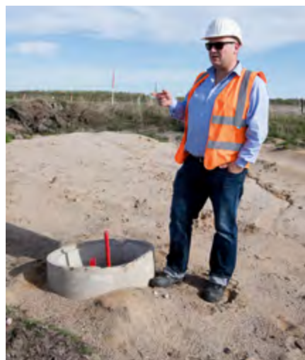
Zuständiger LMBV-Projektmanager Diemo Trepte erläutert einen Setzungsmesspegel.
